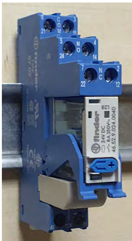
Рисунок 5. Внешний вид и схема модулей реле 4С.02.9.024.0050.SPA
